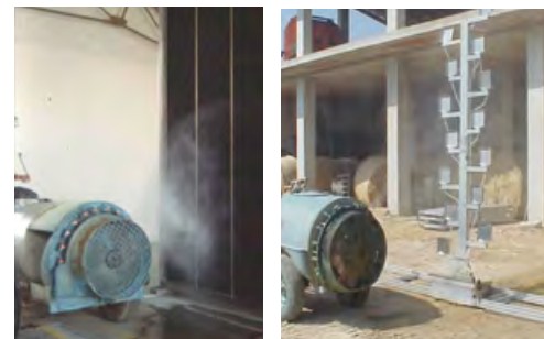
Figura 19 . Equipamento para medição da distribuição vertical da pulverização
