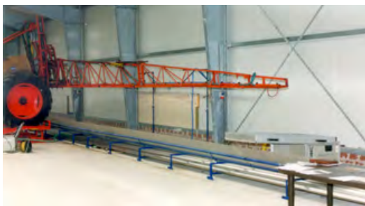
Figura 17 . Equipamento para medir a qualidade da distribuição do cruzamento da pulverização.
