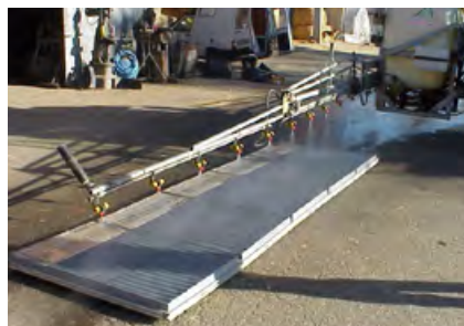
Figura 17 . Equipamento para medir a qualidade da distribuição do cruzamento da pulverização.
