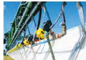
Fig. 18 . Inclinador de cultura. Melhora a penetração do pulverizado
